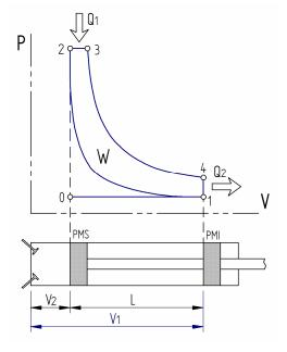
II-A Con ayuda de la figura explique. concisamente, los procesos realizados en un ciclo operativo de un motor térmico, de cuatro tiempos. de encendido por compresión, relacionándolos con los movimientos del pistón.
