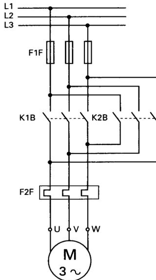
Observa el esquema de la figura, que representa la inversión en el giro de un motor asíncrono trifásico.
