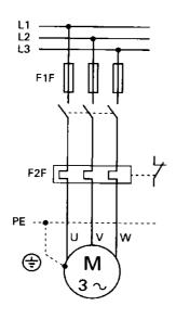
Observa el esquema de la figura, que representa el arranque directo de un motor asíncrono trifásico.
