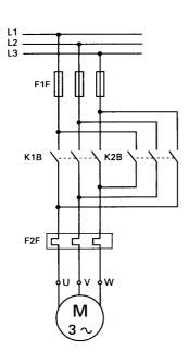
Observa el esquema de la figura, que representa la inversión en el giro de un motor asíncrono trifásico.
